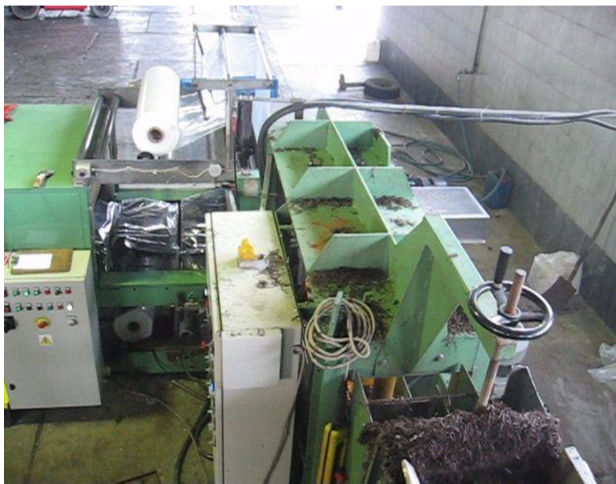
شکل ۲۲- نمایی از دستگاه کمپوست بلوک در حال بسته بندی نهایی بستر رویش قارچ دکمه ای
