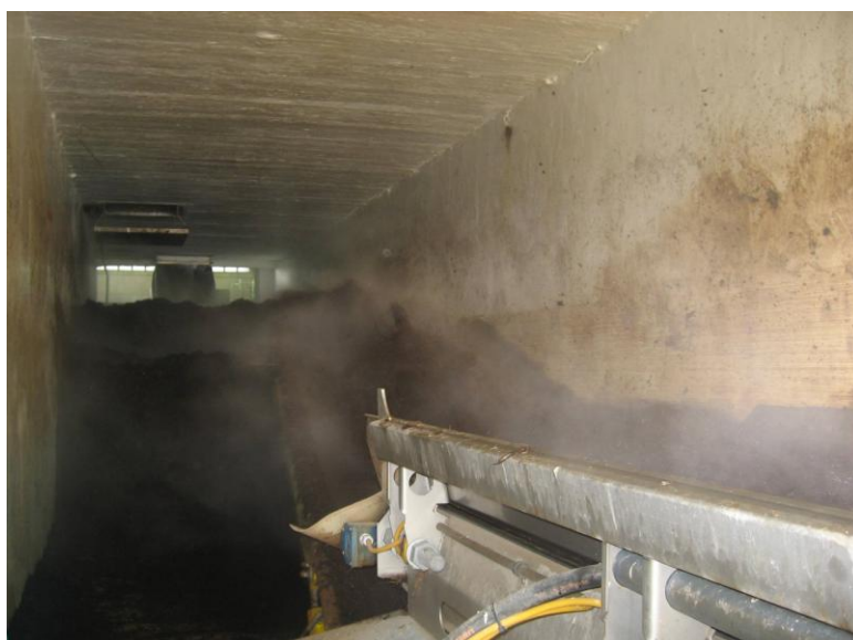
شکل ۹- نمایی از یک تونل پاستوریزاسیون بستر رویش قارچ دکمه ای که در حال پر شدن با بستر رویش قارچ دکمه ای می باشد.
