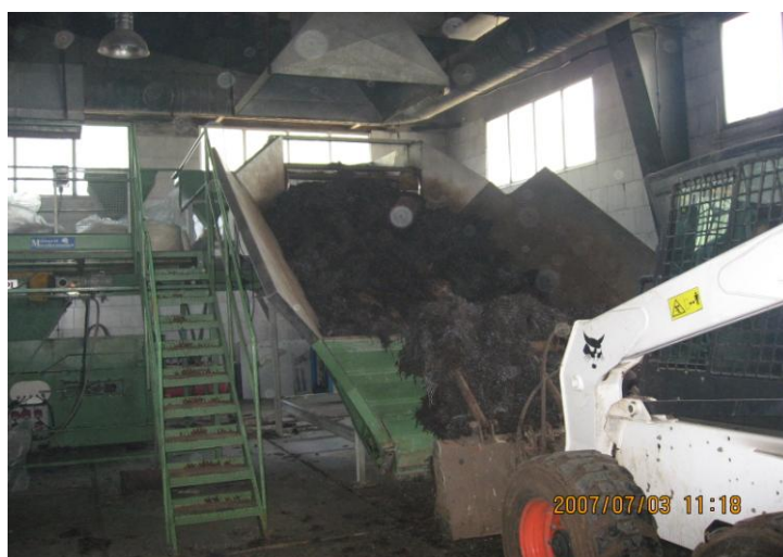
شکل ۲۰- بستر رویش قارچ دکمه ای پاستوریزه شده در حال انتقال به دستگاه کمپوست بلوک می باشد که در طی عبور از دستگاه ، اسپان قارچ در آن کشت شده و نهایتاً به صورت بلوک های پرس شده بسته بندی می شود.
